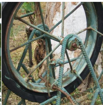
Partie supérieure d'une pompe installée par Viltec
